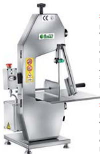
SH.1 2.650 € Potencia: 1 Hp - 750 W Voltaje: 230 V / 1N / 50 Hz Desarrollo sierra: 1550 mm Corte útil: 170 x 150 mm Plano de trabajo: 330x330 Ancho/Profundo/Alto: 530x400x850 Peso: 37 kg
